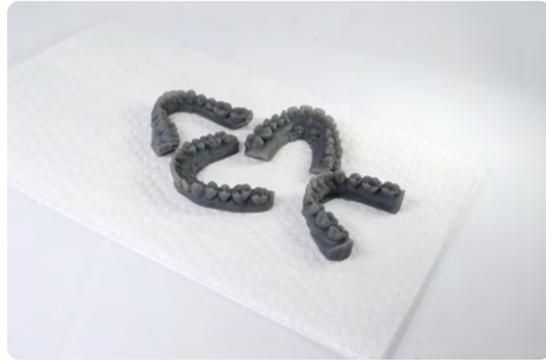
**Consejo:** El aire comprimido puede utilizarse para ayudar a secar las piezas, eliminar la resina atrapada de los espacios pequeños y permitir una inspección rápida de la resina no lavada.
