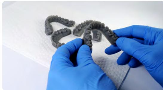
Si queda resina húmeda y sin curar tras el secado, utiliza un bote dispensador de plástico o sumerge la pieza en alcohol isopropílico limpio durante un minuto y vuelve a secar la pieza al aire.
